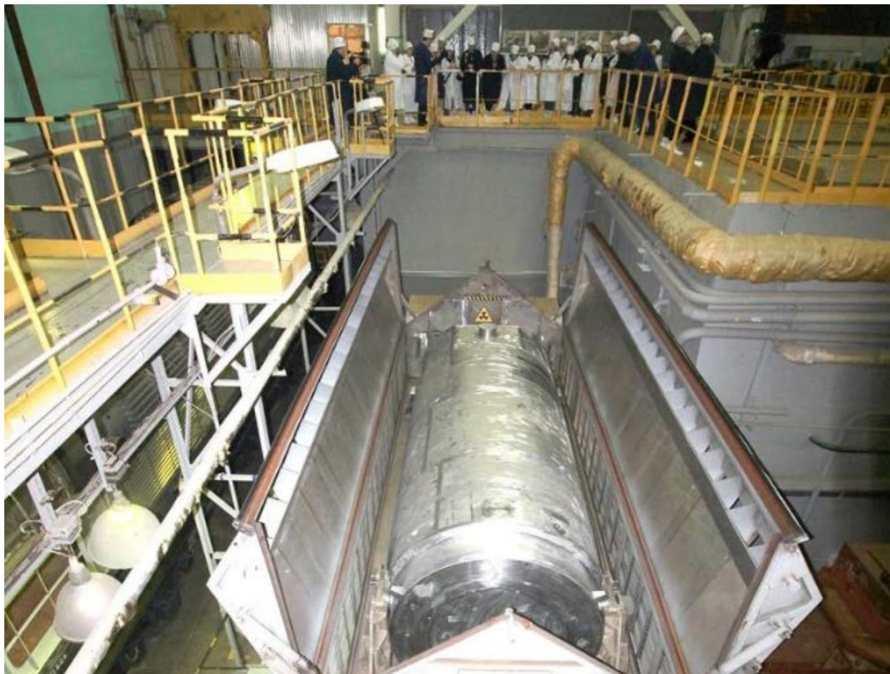
Рисунок 2.1.3 – Подготовка ТУК к перегрузке ОТВС
